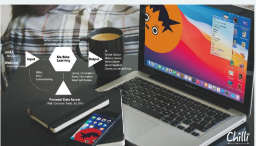
プロアクティブ AI アシスタント開発： ユーザの行動パターンや状態を認識し 状況に合わせた情報を提供する音声アシストシステム
