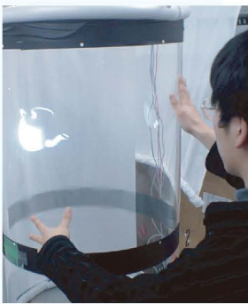
円筒型マルチタッチインタフェース: 3次元CGを編集・開発するためのインタフェースです。通常のマルチタッチインタフェースにおいて可能な操作方法に加えて、両手で挟む操作や、任意の方向からの操作が可能となっています。
