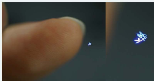
"Fairy Lights in Femtoseconds" フェムト秒レーザーを用いて、任意の三次元空間上に、触れる光の像を描く
