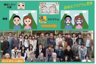
テンプレートマッチングを用いた顔検出プログラム
