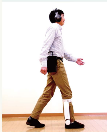
GaitEcho: 歩行リハビリのためのウェアラブル聴覚バイオフィードバックデバイス。ユーザは自身の歩行動作のフィードバック音を手がかりにリハビリ等の運動学習を行う。
