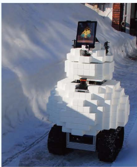
積雪寒冷地のための移動ロボット: 搭載された様々なセンサを活用し、障害物回避や環境地図の作成などの基本機能を持つ他、歩行者の行動予測に基づく人に優しいインタラクションや、人の睡眠覚醒機能に基づき新しい並列知覚情報処理系制御による省電力化や計算機資源の有効活用などの研究を行っています。
