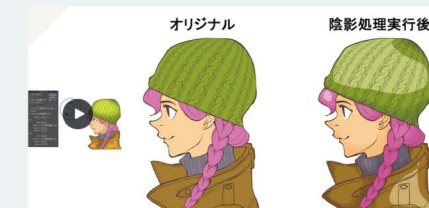
自動陰影生成エンジンの応用例 べた塗りされた閉領域内部に境界に矛盾しない自然な陰影を自動生成する技術が@セルシスと共同開発され、"CLIP STUDIO PAINT ver.2.0.0"に実装されています。(©セルシス)
