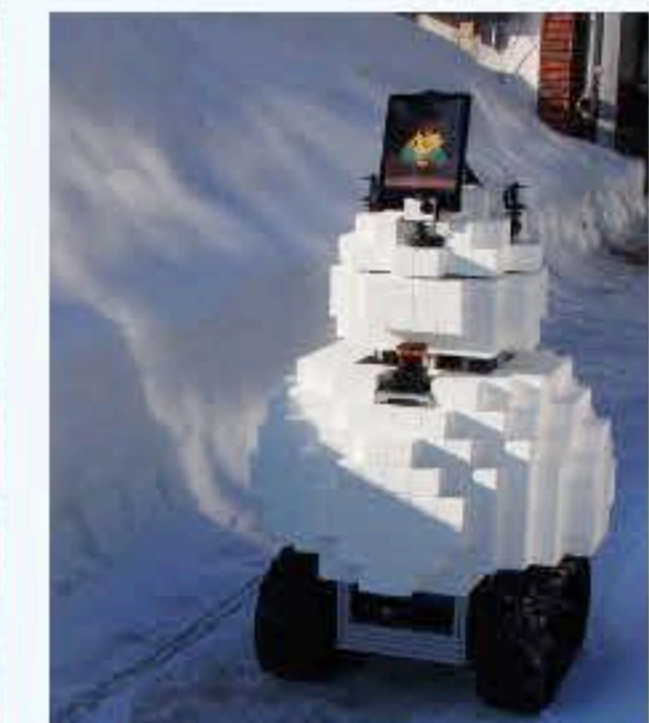
積雪寒冷地のための移動ロボット: 搭載された様々なセンサを活用し、障害物回避や環境地図の作成などの基本機能を持つ他、歩行者の行動予測に基づく人に優しいインタラクションや、人の睡眠覚醒機能に基づく新しい並列知覚情報処理系制御による省電力化や計算機資源の有効活用などの研究を行っています。
