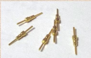
基盤の穴につける足です。基盤と基盤をつなぐために使います。今回は 7セグシリアルディスプレイの基盤の穴に足をつけて、ブレッドボードに挿すためのつかい
