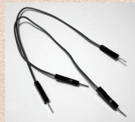
ジャンパワイヤは Arduino の pin と部品をつなぐ線です。普通の単線をつかってもいいのですが、柔らかくて皮膜がはがれている部分の上部がプラスチック加工してあるものだと、見栄えもよく扱いやすいです。
