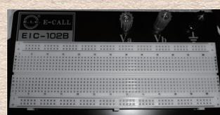
基盤にハンダ付けしなくても、部品を挿すだけで簡単に回路がつくってしまう魔法のボード。一つ一つの穴に接点があっていて、列が電氣的につながっているんです。ハンダ付け不要なので簡単に差し替えでき、全部抜いて再利用とかも可能。
